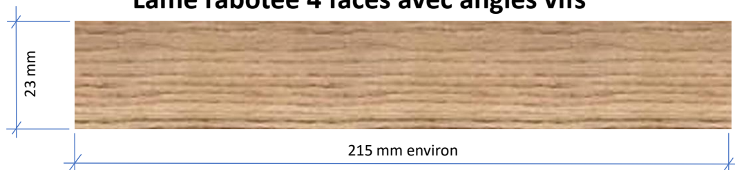
Lame rabotée 4 faces avec angles vifs
