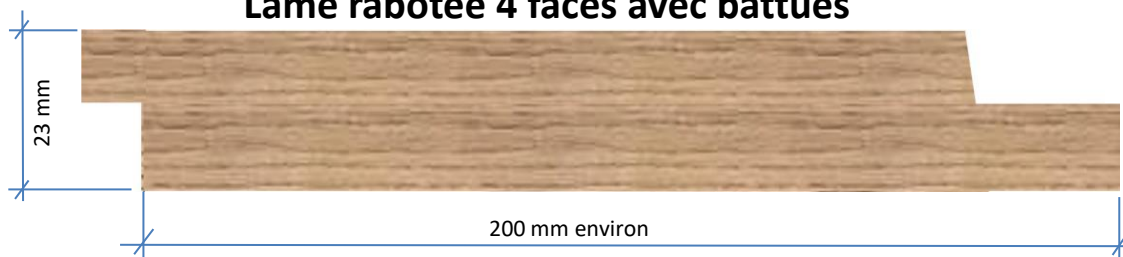
Lame rabotée 4 faces avec battues
